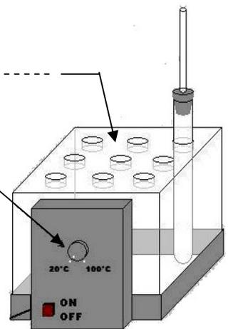
Chauffer le tube dans le bain-marie pendant 10 minutes tout en surveillant le mélange situé dans le tube à essais afin qu'il ne se mette pas à bouillir. En cas d'ébullition, baisser le thermostat.
