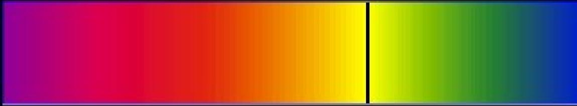
Spectre d'absorption d'une vapeur de sodium
